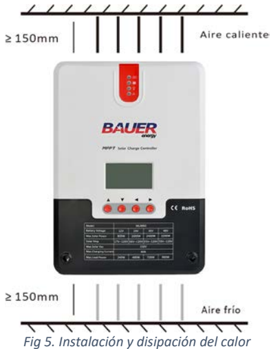
Fig 5. Instalación y disipación del calor
